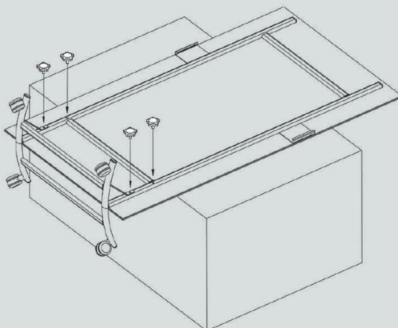
[ES] Conecte la base con el espejo y atorníllela mediante los tornillos de sujeción.
