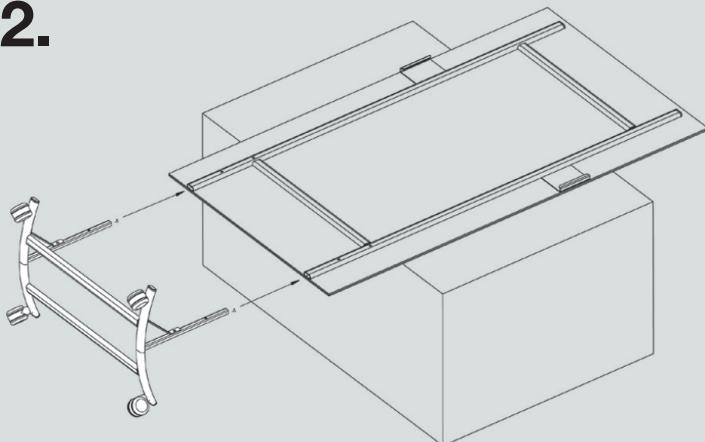
[ES] Introduzca las guías de la base en las del espejo, hasta hacer coincidir los tornillos de sujeción con los orificios de las guías del espejo.
